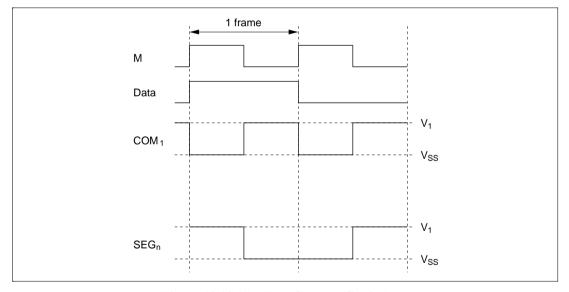
Figure 13.13 (d) Waveforms at Static Duty
