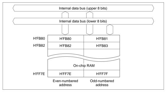
Figure 7.1 RAM Block Diagram (H8/3834)
